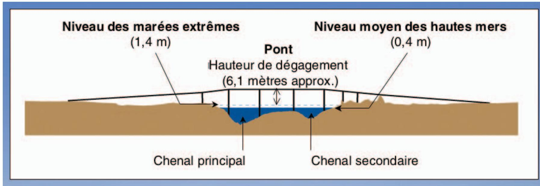
Figure 22 Géométrie du pont de la variante retenue.
