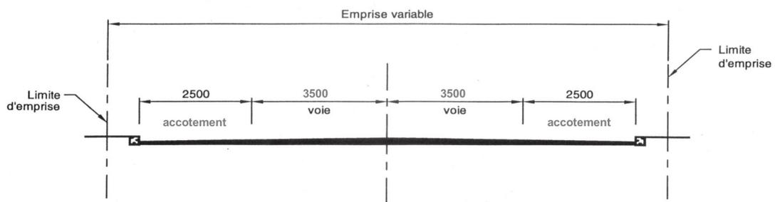
Figure 1 Profils de la route et du pont pour le projet retenu.
