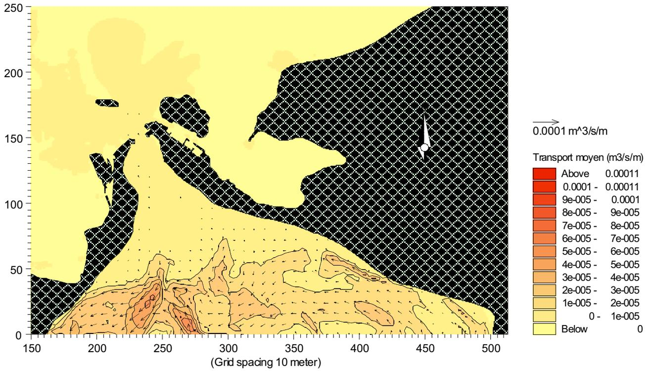
Annexe 6.2 Transport net (m<sup>3</sup>/s/m) de sédiments non cohésifs calculé par le modèle MIKE21-ST sur une période d'exactly deux cycles de marée diurne, du 4 au 6 juin 2001.
