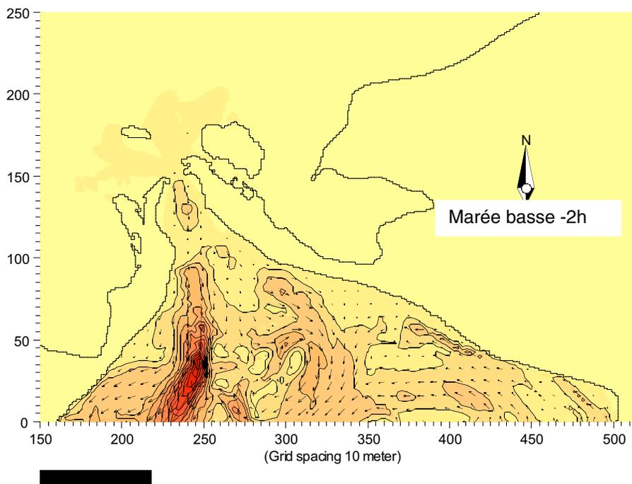
Annexe 6.1 Transport de sédiments instantané calculé par le modèle ST sur la grille G2m10, lors des plus forts courants de flot (haut) et de jusant (bas) calculés par le modèle HD sur la même grille.
