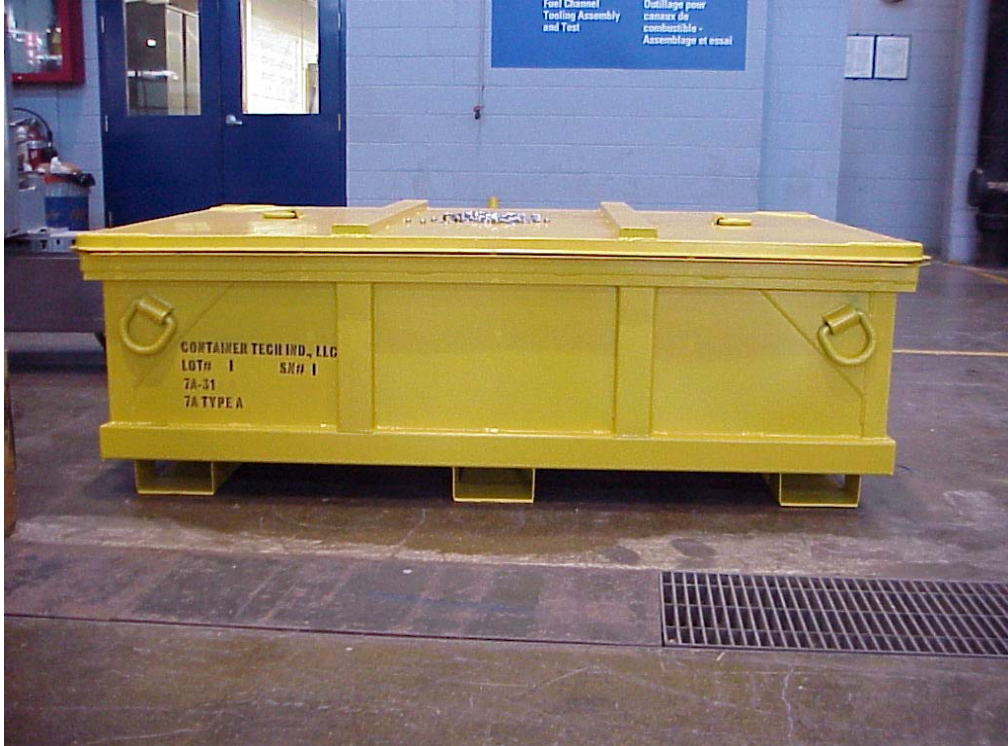
Figure 7-7 : Boîte en acier de 1,24 m 3 pour les déchets non compactables de faible et de moyenne activité de retubage
