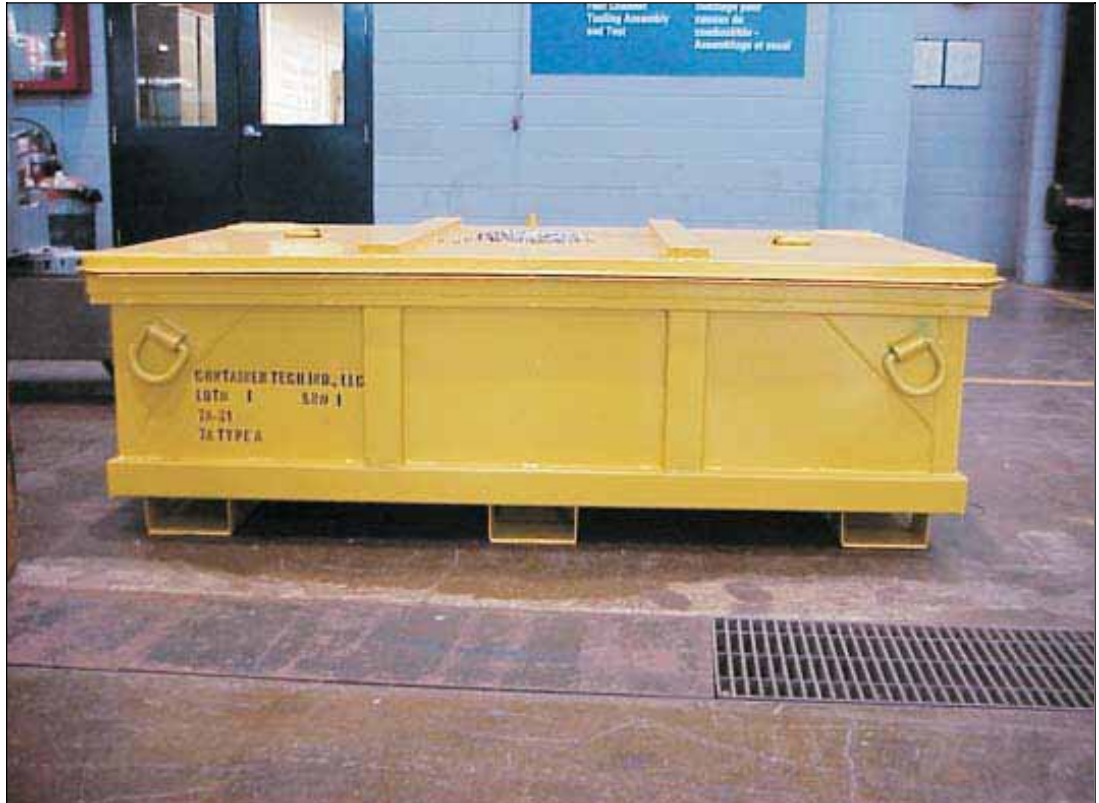
Figure 3-9 : Boîte métallique pour le transfert et le stockage des déchets non compactables de faible et de moyenne activité résultant du retubage
