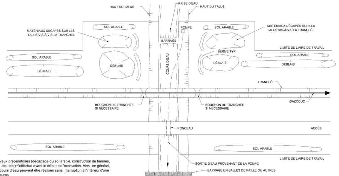
Notes: - L'ensemble des travaux préparatoires (décapage du sol arable, construction de bermes, soudage de la conduite, etc.) s'effectue avant le début de l'excavation. Ainsi, en général, les travaux dans le cours d'eau peuvent être réalisés sans interruption à l'intérieur d'une période de 6 à 15 heures.
