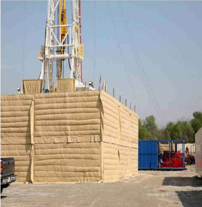
Image 4. Des murs anti-bruit disposés autour d'une tour de forage
