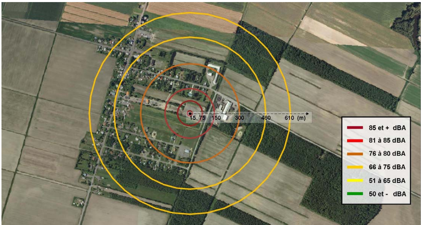
Figure 6. Niveau sonore 6 perçu à différentes distances 7 , émis par l'équipement utilisé lors de la fracturation hydraulique, appliqué au puits A-254 de Gastem à Saint-Louis, Québec
