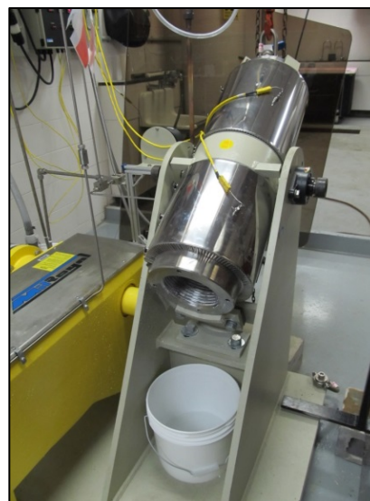
Figure 5 Réacteur incliné pour le nettoyage et la récupération des solides
