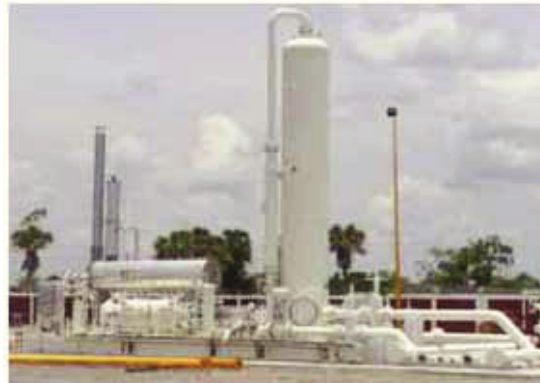
Figure 3-7 Unité de déshydratation des gaz (Source : Kocken Sistemas de Energia Inc., Internet)
