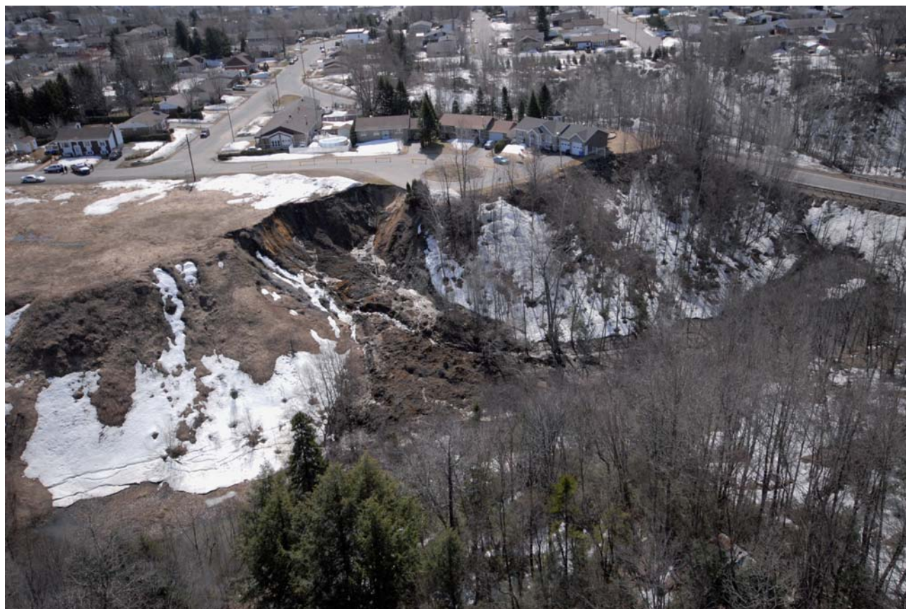
Figure 3 Glissement rotationnel (survenu à Shawinigan en 2008)
