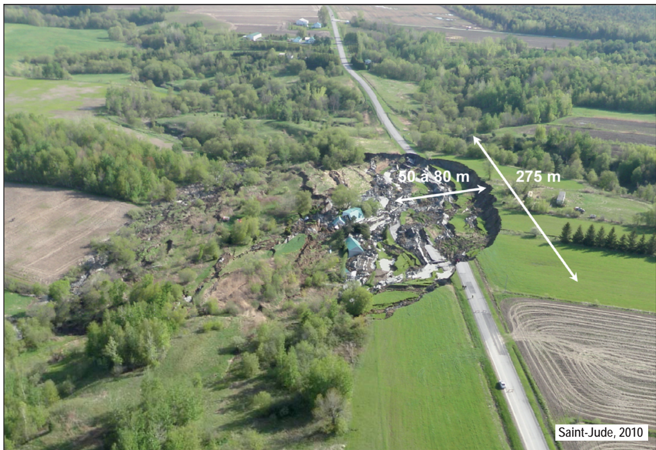
Figure 5 Exemples de glissements fortement rétrogressifs (survenus dans les basses terres du Saint-Laurent)
