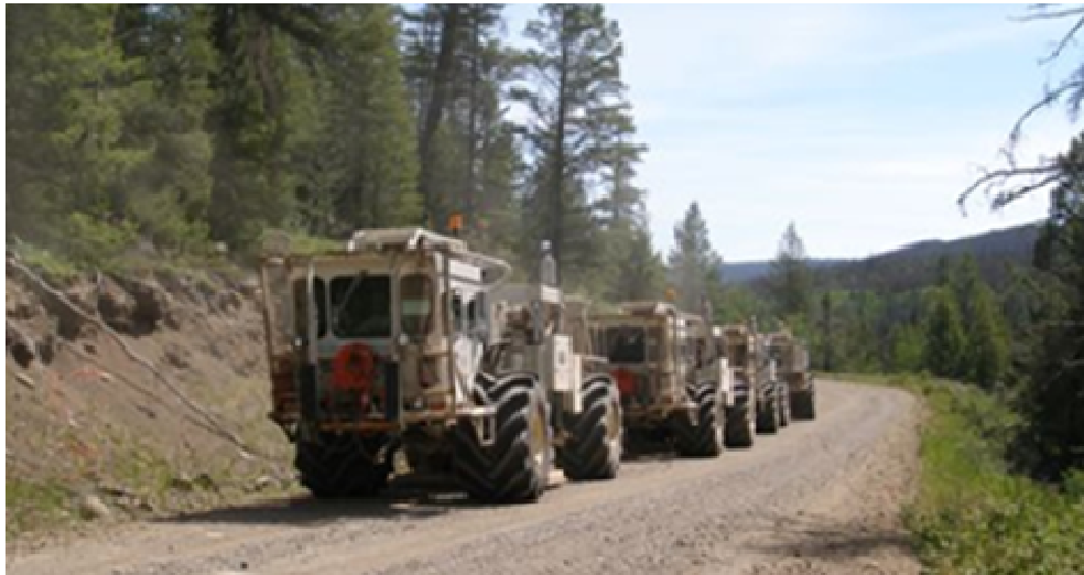
Figure 3 : Camions vibreurs employés pour les levés sismiques.
