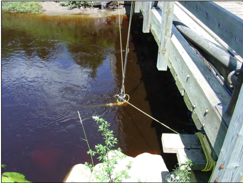
POMPE ÉLECTRIQUE SUBMERSIBLE DÉPLOYÉE DANS LA RIVIÈRE HURON DANS LE CADRE DES TRAVAUX DE FRACTURATION HYDRAULIQUE À SAINT-ÉDOUARD-DE-LOTBINIÈRE. (2009)
