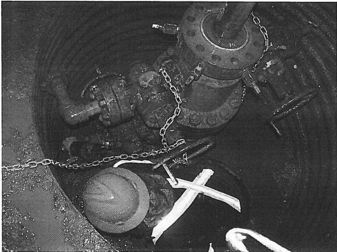
Émissions de gaz à l'évent du coffrage de surface
