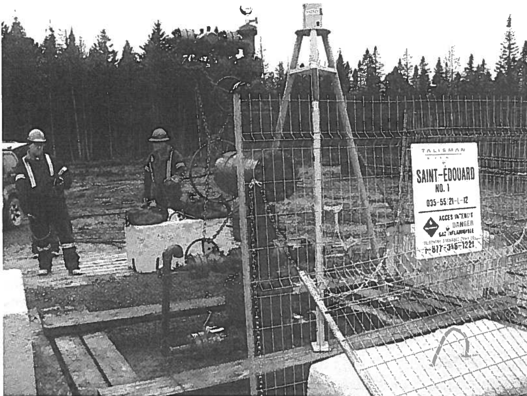
Tête de puits, prélèvement des émissions de gaz aux abords du coffrage conducteur
