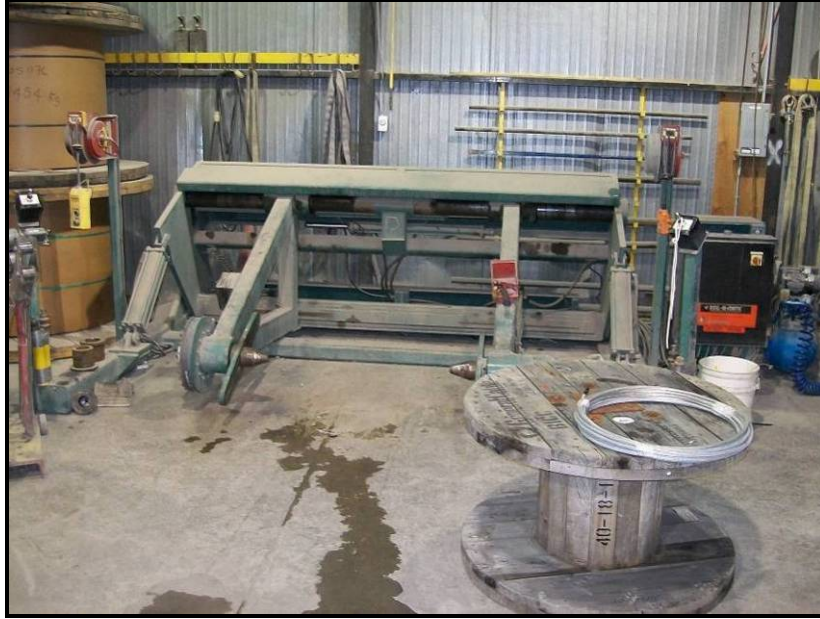
Photo n° 37 (2009-12-01) : Machine pour enrouler le fil de métal dans les tourets dans le bâtiment R.
