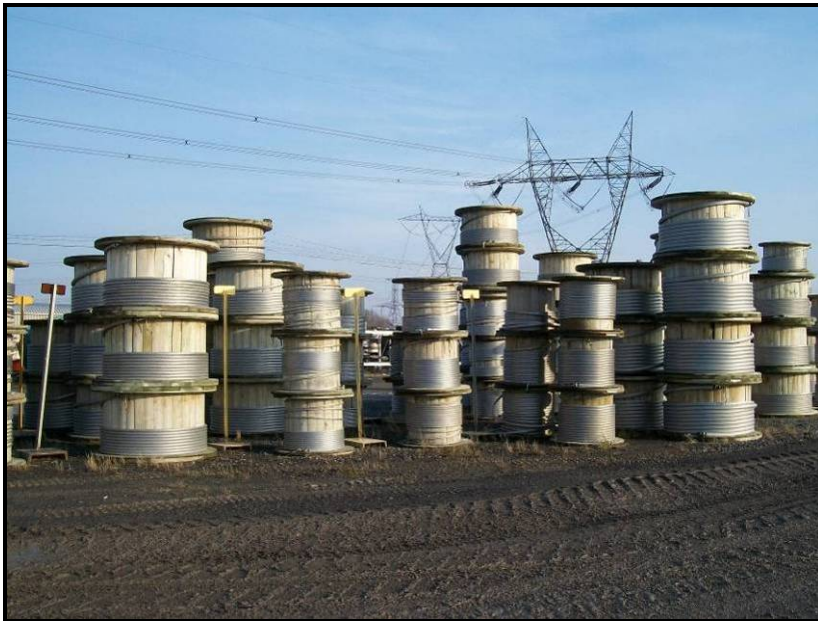
Photo n° 79 (2009-12-02) : Entreposage de tourets en bois traité à l'arséniate de cuivre chromaté dans la zone d'entreposage n° 30.
