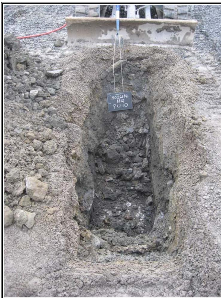
**PHOTO 4 :** Intérieur du puits d'exploration PU-10 où des sols dans la plage « B-C » ont été observés.
