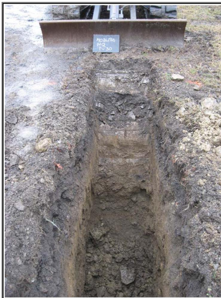
**PHOTO 8 :** Intérieur du puits d'exploration PU-30 où des sols dans la plage « A-B » ont été observés.
