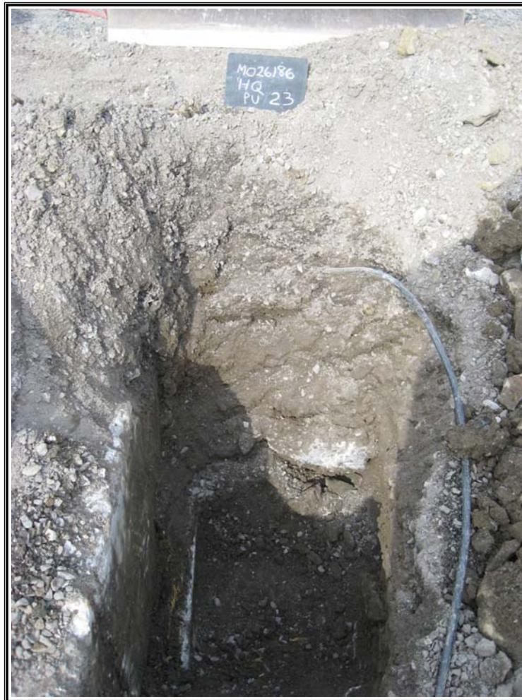
**PHOTO 6 :** Intérieur du puits d'exploration PU-23 où des structures de béton désaffectées ont été observées.
