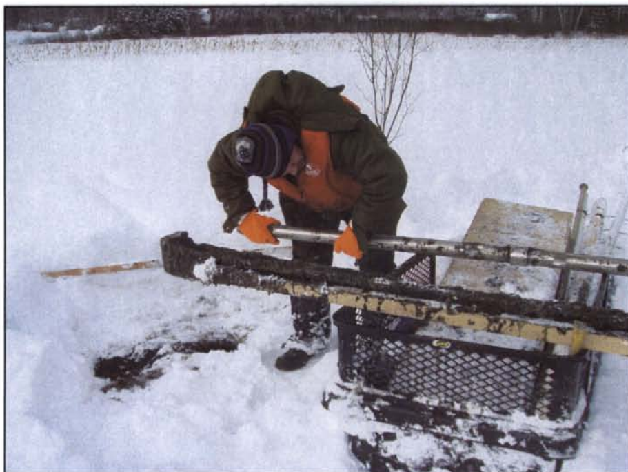
Photographie # 5 Utilisation d'un carottier de type "Ogeechee corner". Saint-Donat, Québec
