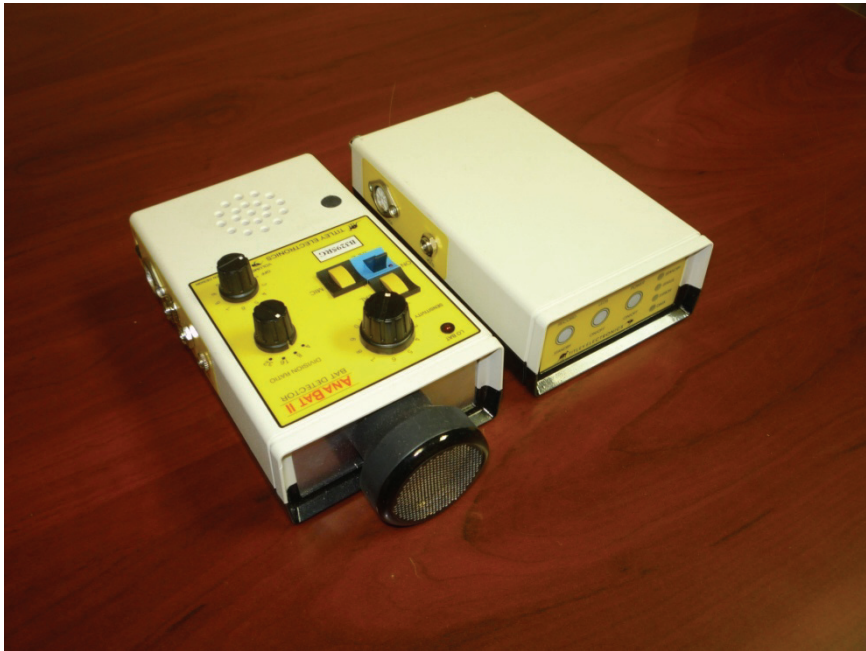
Figure 2 Appareil de détection Anabat II Bat Detector et module de contrôle et de stockage CF Storage ZCAIM
