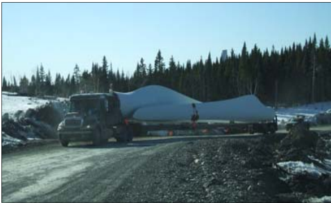
◀ Transport des composantes - Poids des sections de tours : de 30 à 60 tonnes
