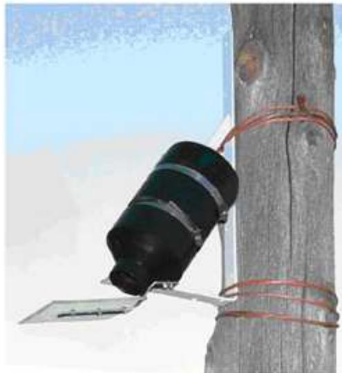
Figure 1 Dispositif contenant un détecteur Anabat
