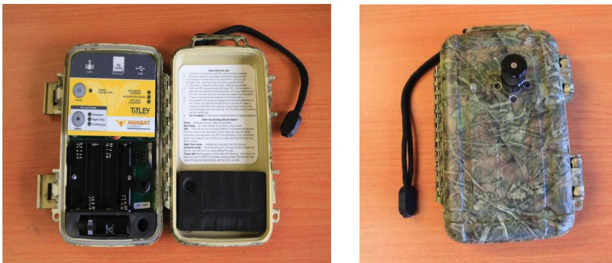
Figure 2 Système automatisé d'enregistrement AnaBat Express
