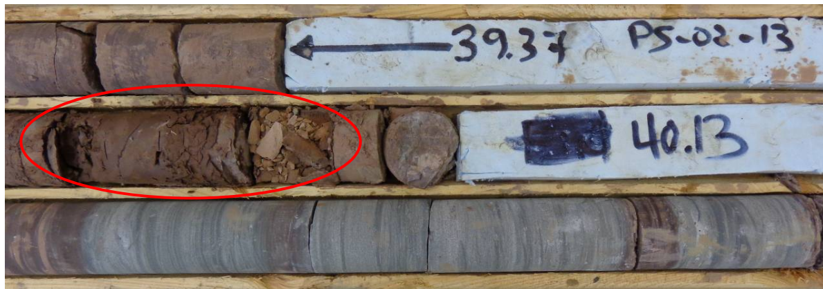
Photographie n° 2 : Strate de remplissage de silt avec un peu d'argile observée dans le roc à PS-02-13 (39,9 m à 40,1 m)
