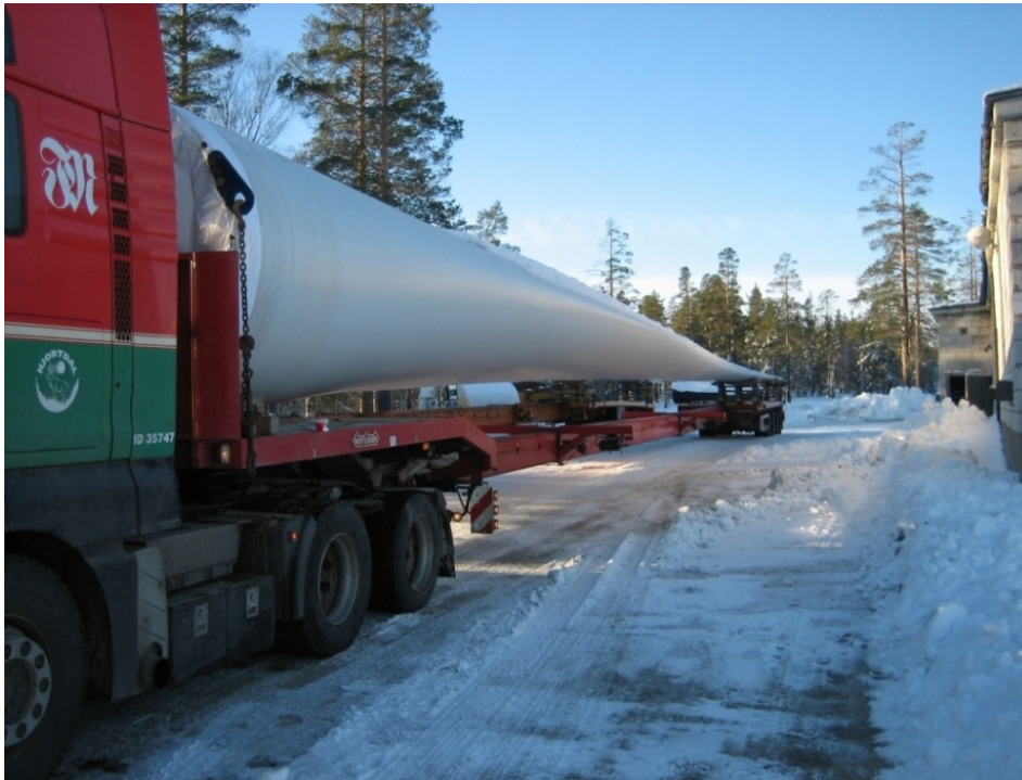
Figure 3.3 Transport par camion d'une pale en milieu forestier
