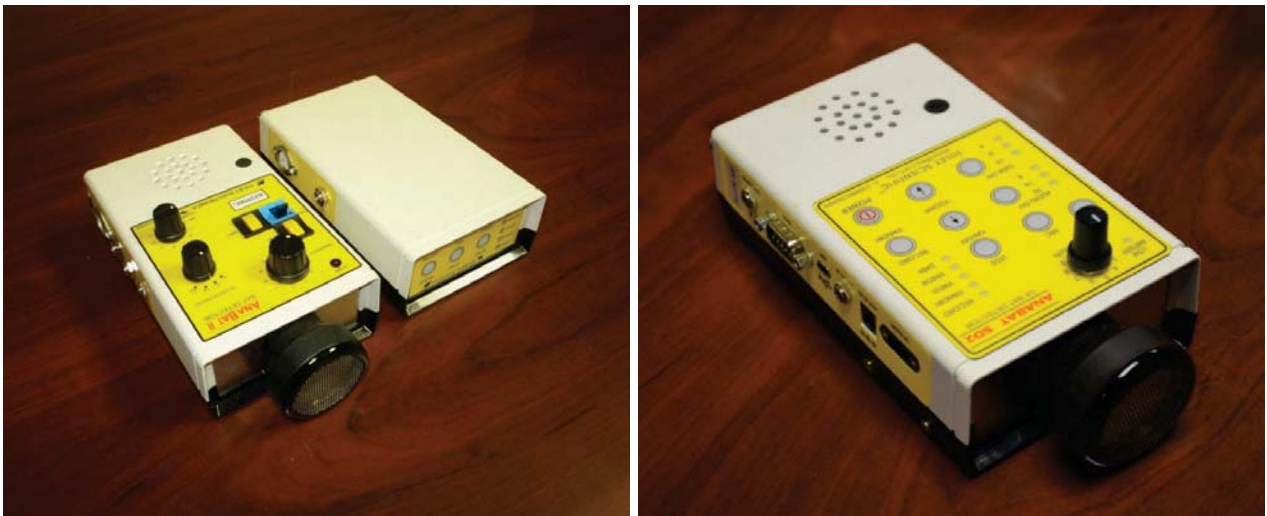
Figure 2 Systèmes automatisés d'enregistrement AnaBat II (à gauche) et SD 2 (à droite)
