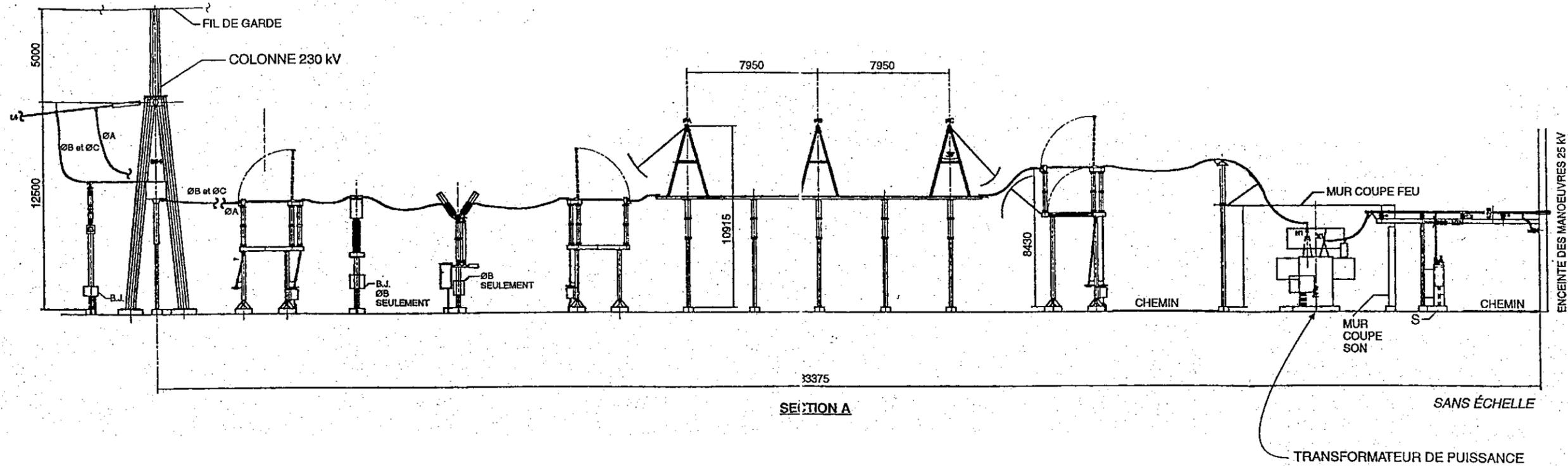
FIGURE (2 de 2) — PLAN TYPE ET DESCRIPTION DU POSTE ÉLÉVATEUR (230 Kv)
