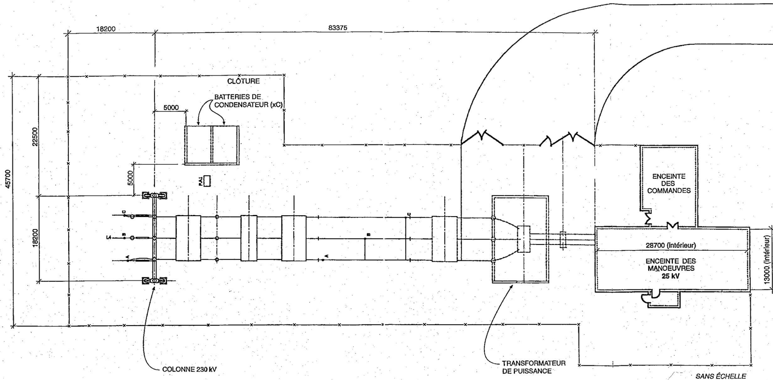
FIGURE (1 de 2) — PLAN TYPE ET DESCRIPTION DU POSTE ÉLÉVATEUR (230 Kv)
