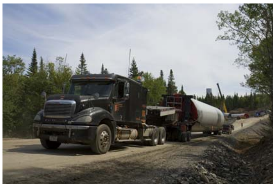
Transport d'une section de tour
