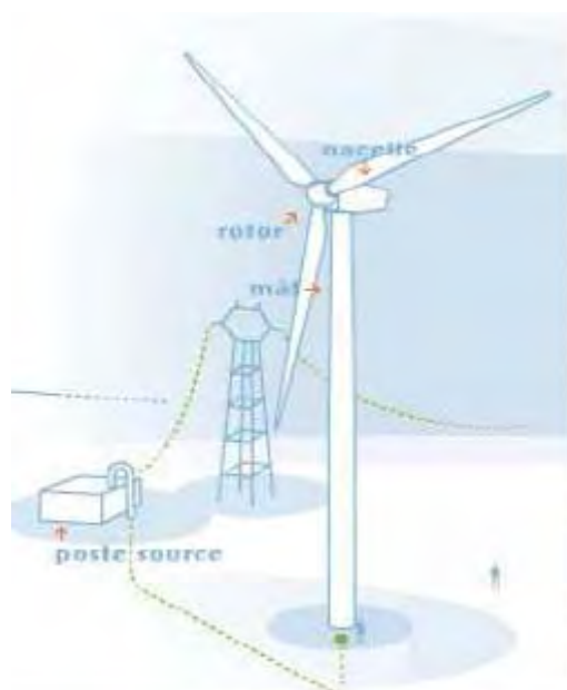
Figure 1 : Eléments d'une éolienne
