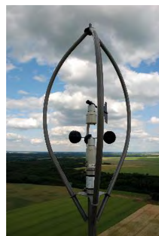
Figure 4 : Anémomètre situé sur la nacelle de l'éolienne
