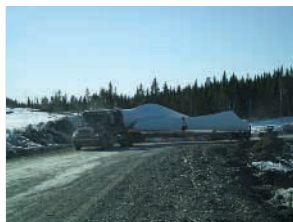
Transport des composantes Une pale d'éolienne pèse environ 8 tonnes.
