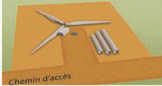
Excavation de la fondation Diamètre de la fondation de surface : environ 16,3 m
