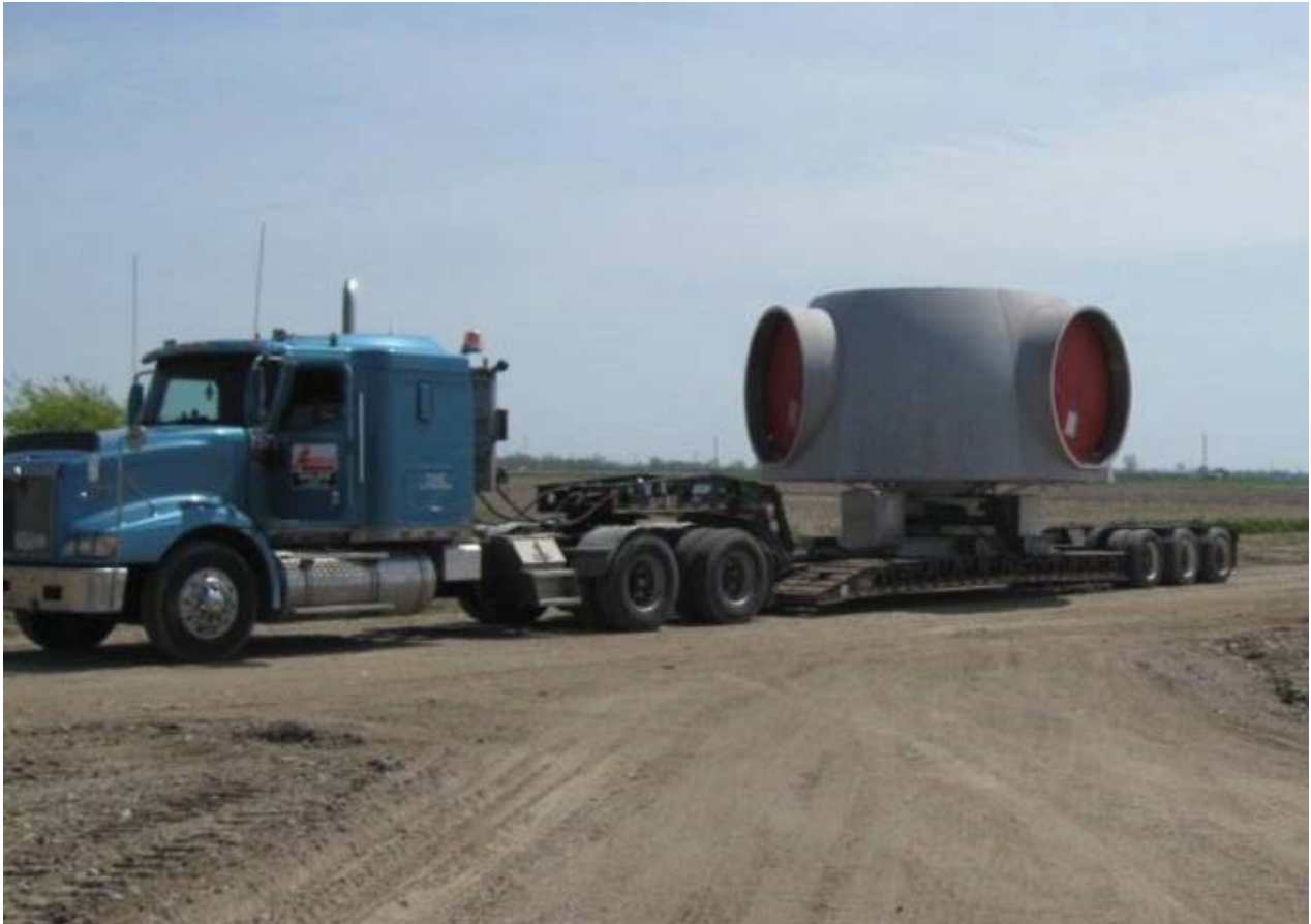
Photo 3.2a Transport d'un cône d'éolienne
