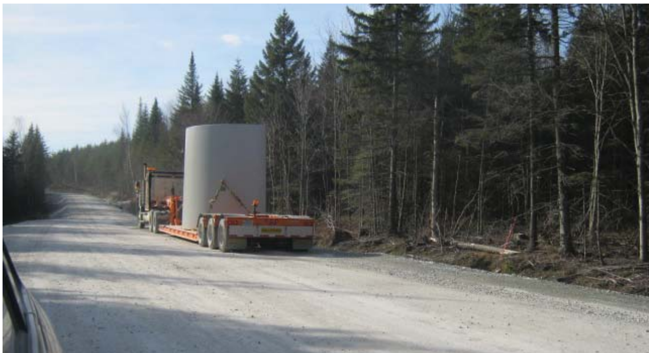
Photo 3.1 Transport d'une section de tour
