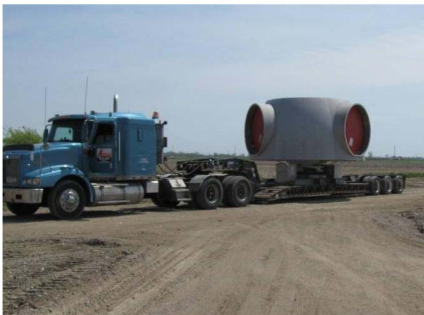
**Figure 3.1**      **Transport d'un cône d'éolienne**
