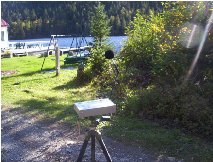
Figure 1 : Analyseur Larson-Davis installé à proximité d'un chalet
