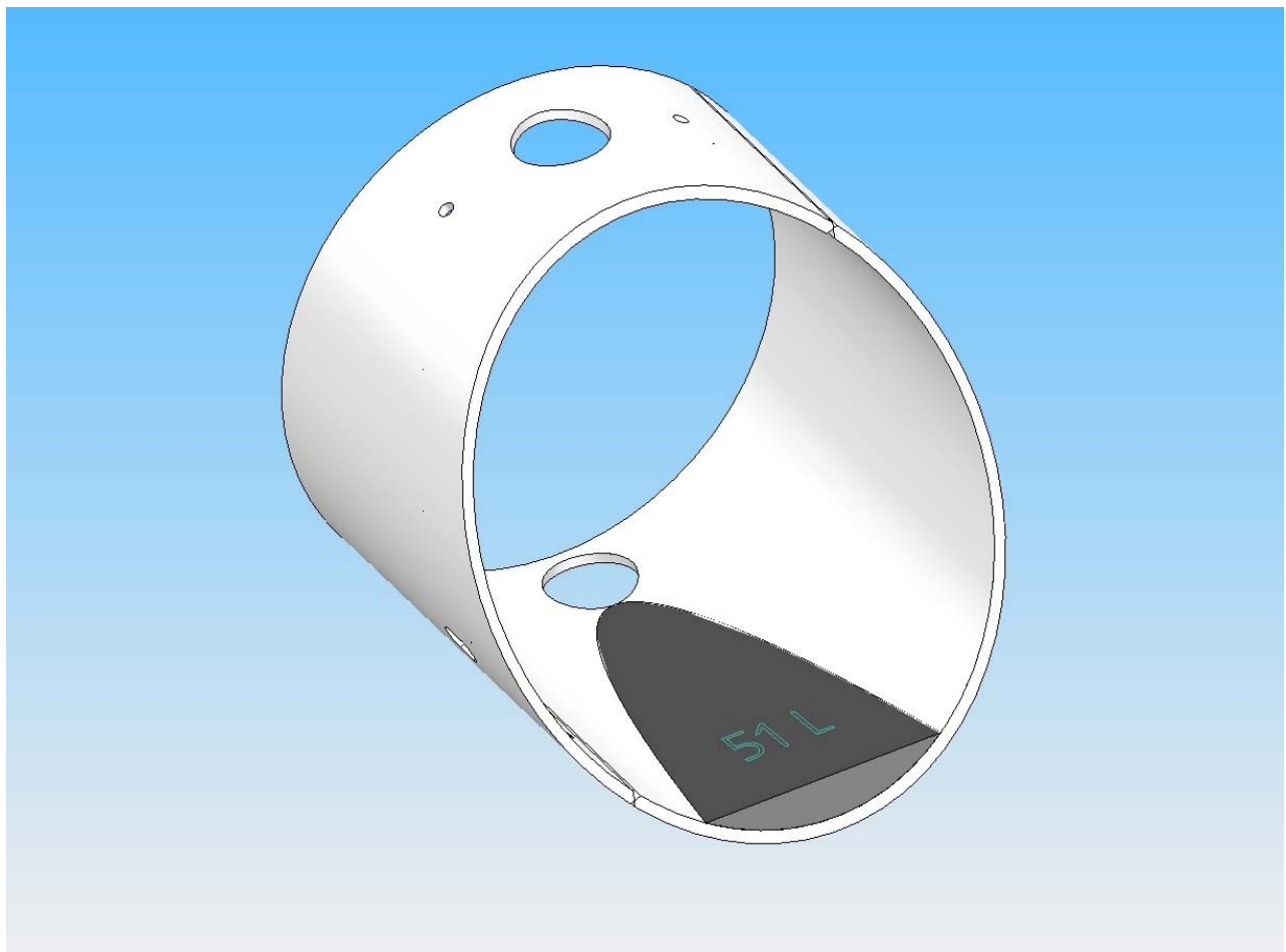
Figure 13 système de rétention des fluides à l'intérieur de la structure en acier
