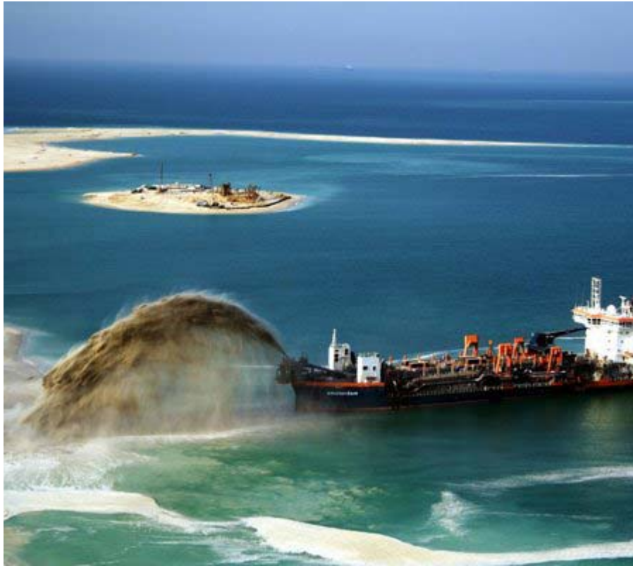
Figure 9.2 Drague hydraulique (type « à élinde traînante » ou « Hopper suction ») projetant des sédiments sur une plage
