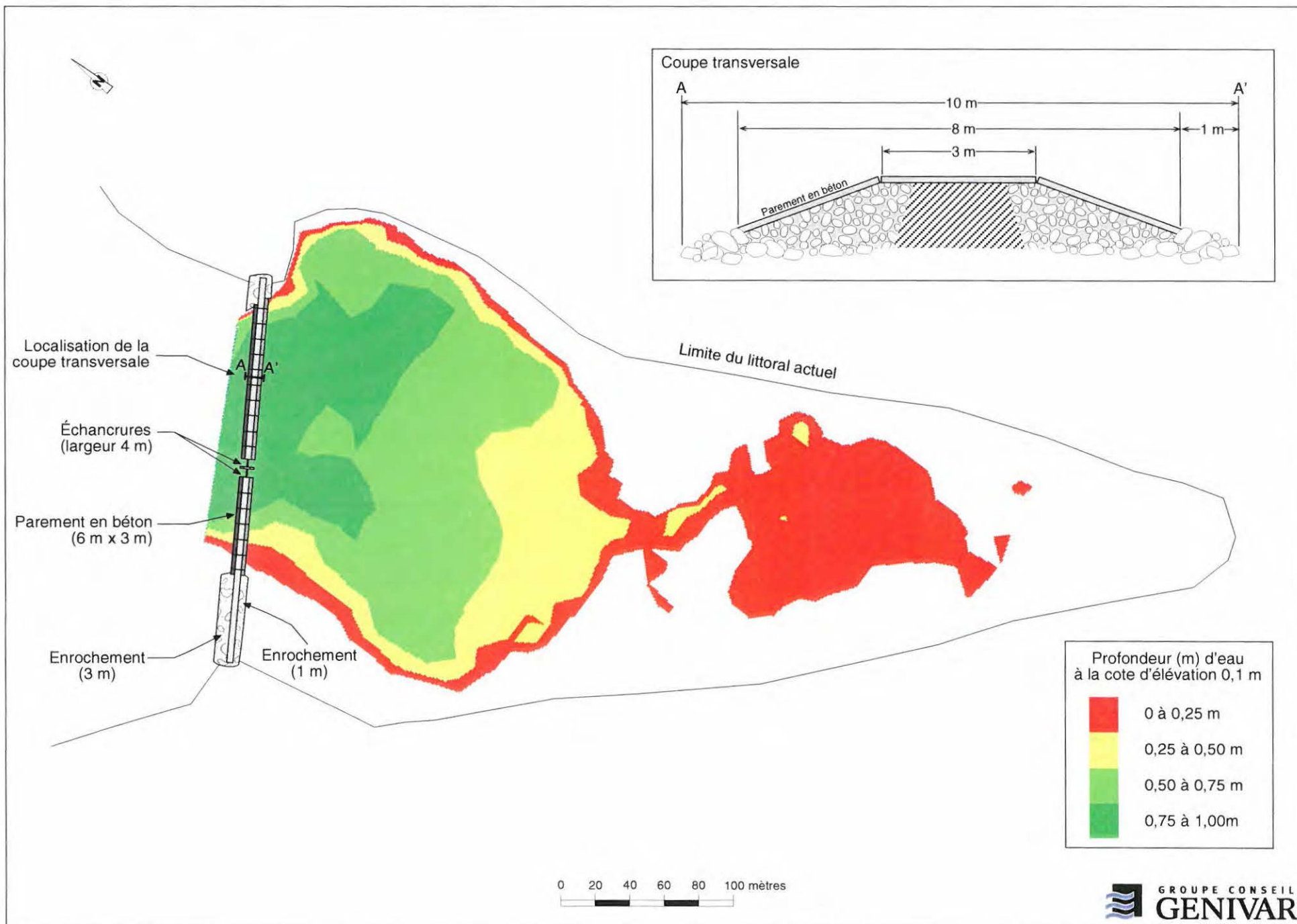
FIGURE 7. Scénario 3. Déversoir en parement de béton articulées.
