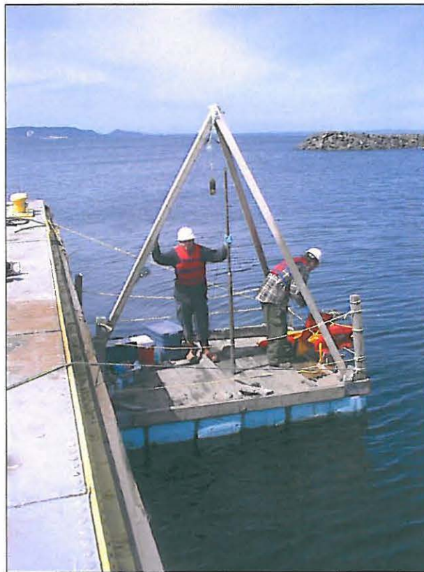
Photo 6. Barge et carottier manuel employés pour l'échantillonnage
