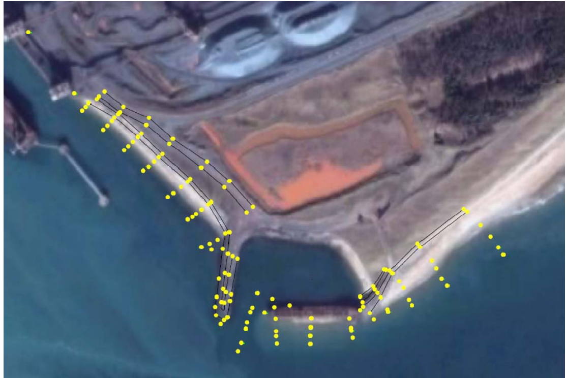
Figure 9 Position des points de levés topographiques entre le Bassin des Remorqueurs et le quai n° 2.
