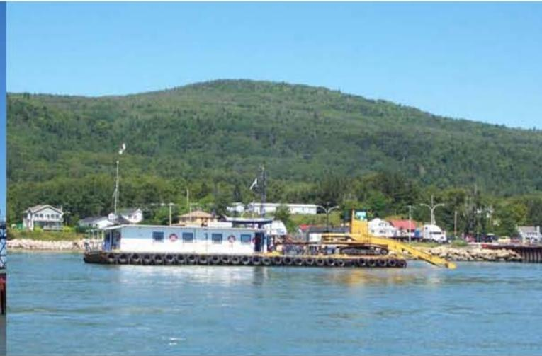
Drague mécanique montée sur une barge (Groupe Ocean)
