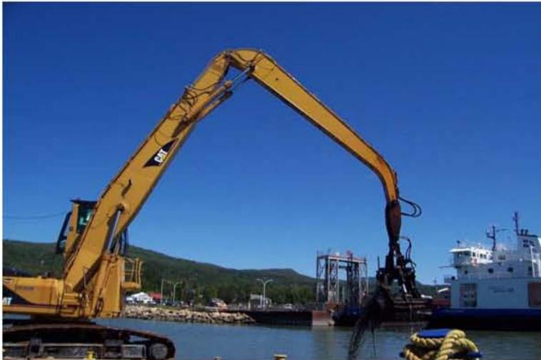
Drague mécanique à benne preneuse (Groupe Ocean)
