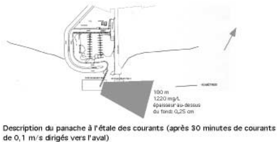
Figure 7: Modélisation des panaches de dispersion et direction des vents dominants à Saint-Laurent-de-l'Île-d'Orléans
