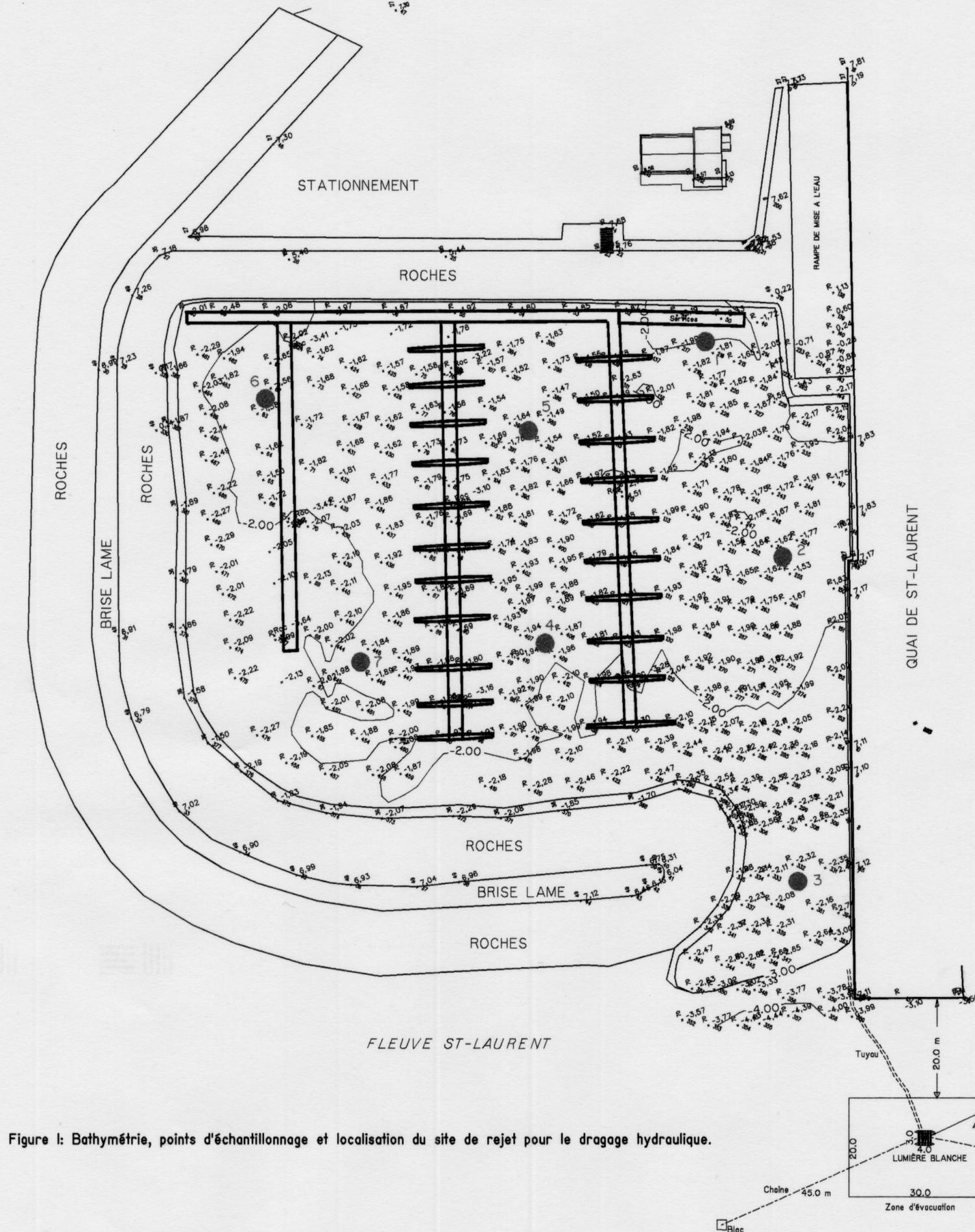
Figure I: Bathymétrie, points d'échantillonnage et localisation du site de rejet pour le dragage hydraulique.
