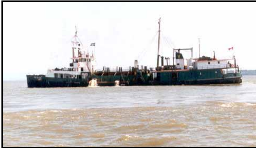
Photo 4 : Drague à suction autoporteuse à élinde traînantes
