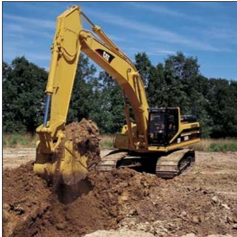
Figure 1 : Cette pelle hydraulique, une fois placée sur un chaland, constitue la drague rétrocaveuse.
