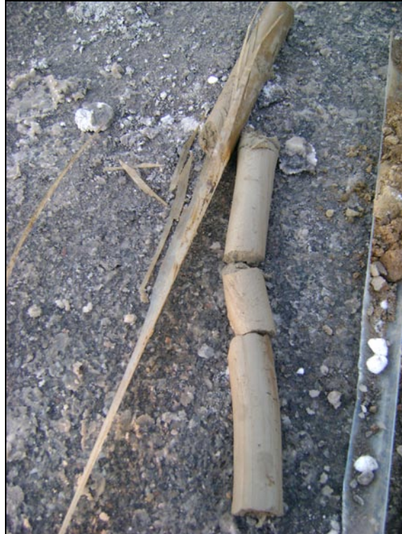
Photographie #2 Forage 1 (profondeur 120 à 240 cm)
