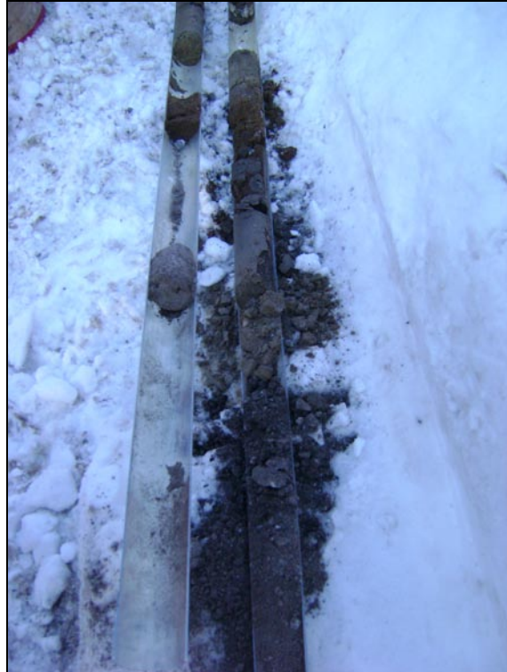
Photographie #4 Forage 2 (profondeur 0 à 120 cm)
