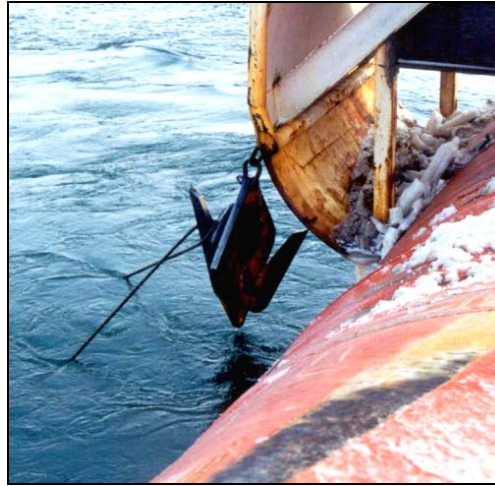
Figure 6: Grappin remontant un câble endommagé
