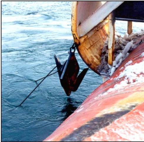
**Figure 4-6: Grappin remontant un câble endommagé**
