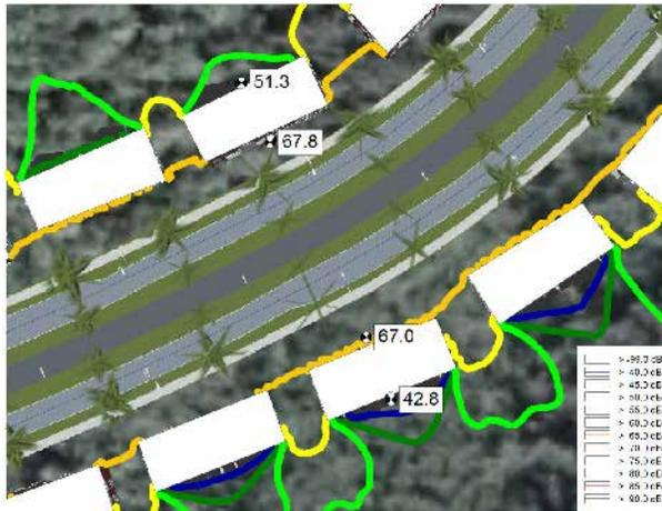
Figure 11 : Projection du bruit le jour au balcon arrière du 3e étage (scénario modélisé avec Cadna-A)
