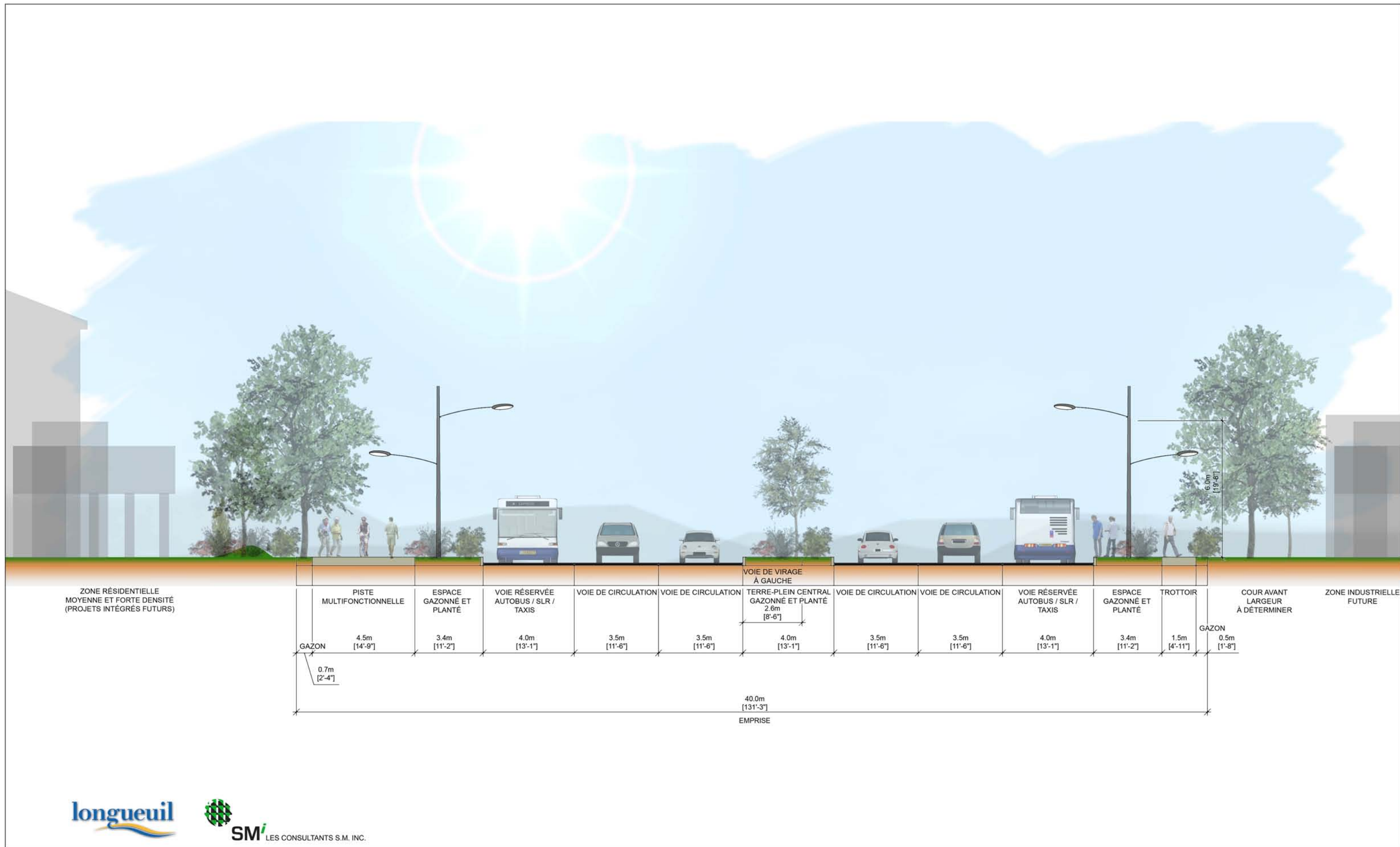
Figure 19 : Coupe type du futur boulevard Moïse-Vincent Vue vers le nord
