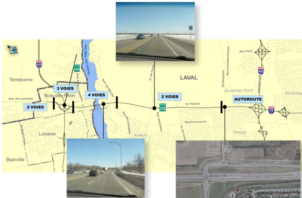
Figure 3-7 Nombre de voies, R-335 entre le boulevard Industriel et l'A-440, selon le tronçon, 2008
