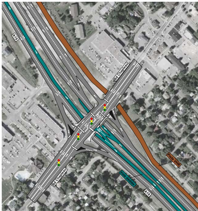
Figure 3-48 Schémas de principe des aménagements de la voie dédiée à gauche, secteur du boul. Adolphe-Chapleau
