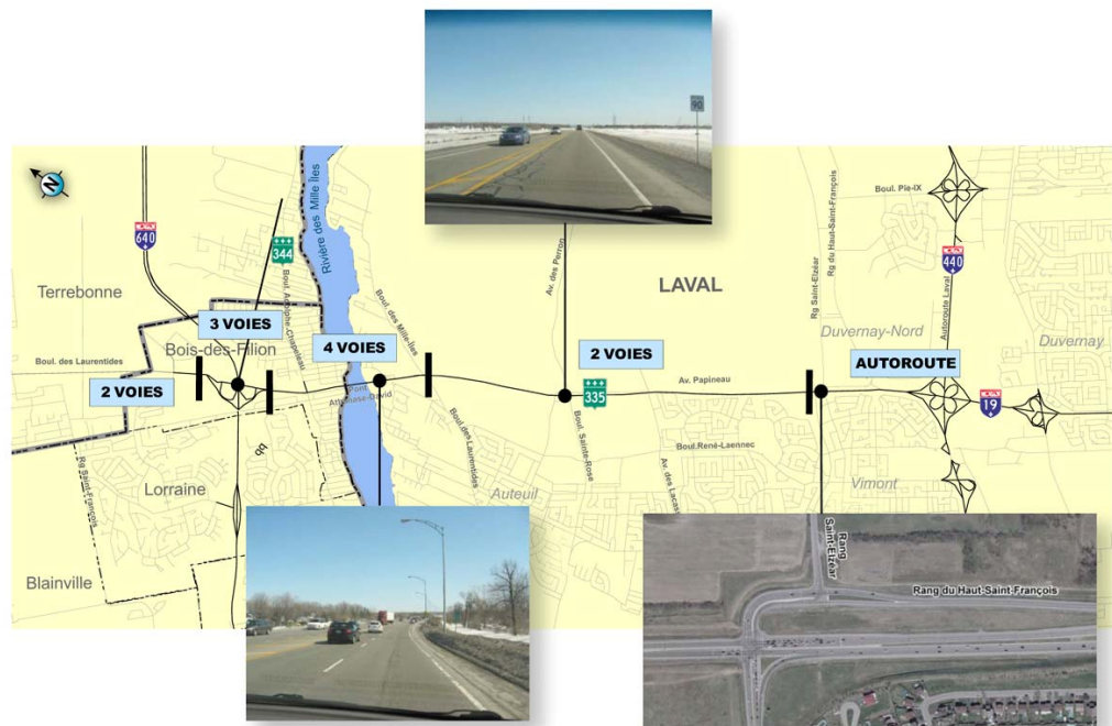
Figure 3.1 Nombre de voies, R-335 entre le boulevard Industriel et l'A-440, selon le tronçon, 2008
