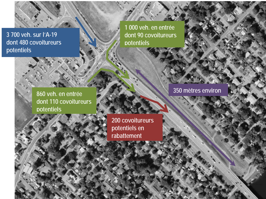
Figure 6 Échanges au niveau de l'échangeur A-19/Adolphe-Chapleau, HPAM
