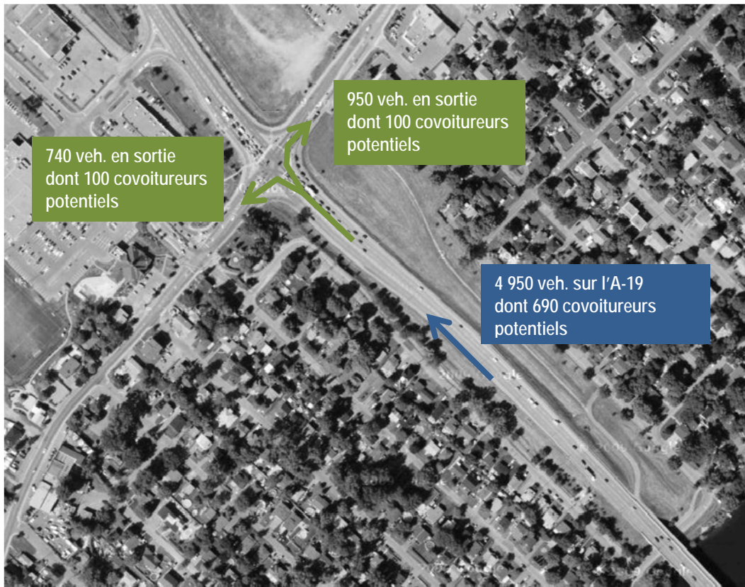
Figure 7 Échanges au niveau de l'échangeur A-19/Adolphe-Chapleau, HPPM
