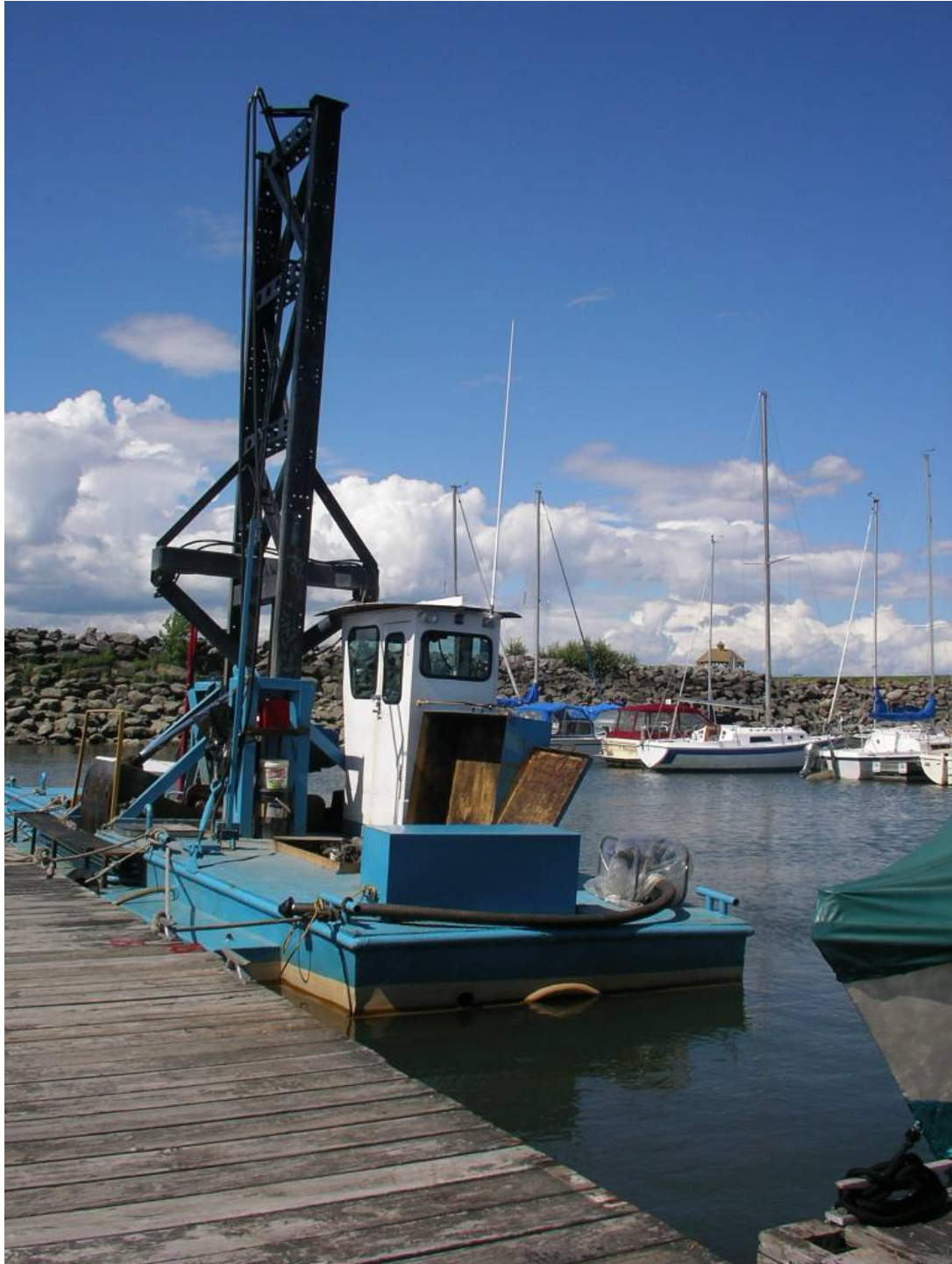
Photo 3.1 Dragage mécanique à benne preneuse développée par la S.D.A.S.M.I.
