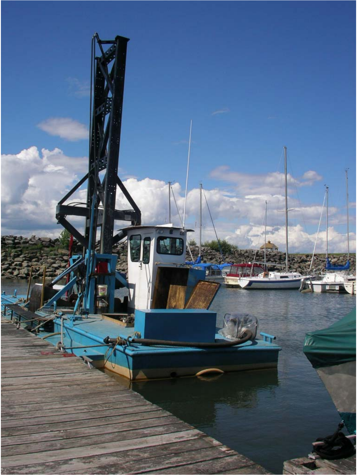
Photo 3.1 Drague mécanique à benne preneuse développée par la S.D.A.S.M.I.
